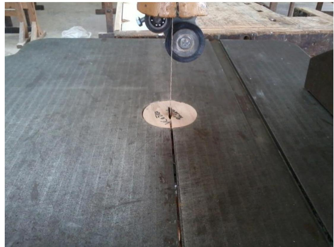
Vůle mezi povrchy vložky a pilového pásu nesmí být větší než 3 mm.
