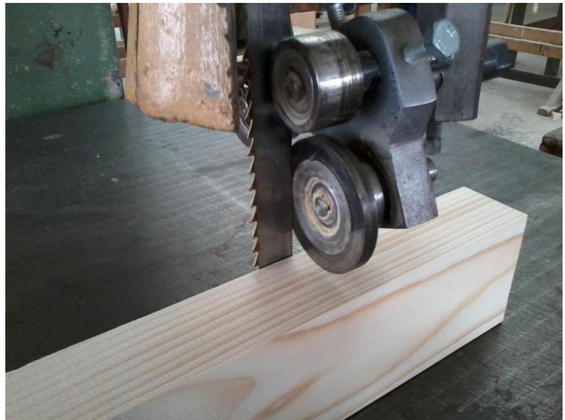
Vodící zařízení pilového pásu musí být nastavitelné tak, aby se při práci pilový pás a vodící zařízení nezahřívaly a aby se nezvyšovala hladina hluku. Vůle ve vodítce musí stanovit výrobce v průvodní dokumentaci.
