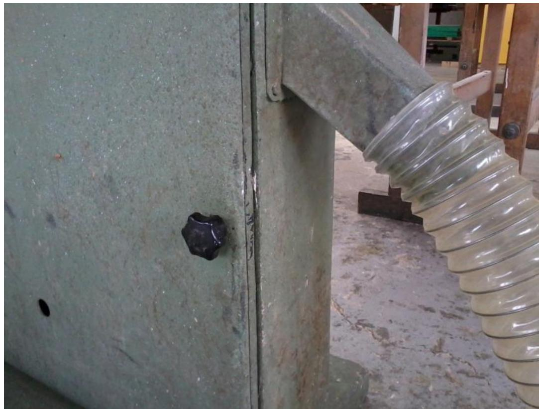
Ochranné kryty pilového pásu s otevíratelnou částí musí být opatřeny uzávěrem znemožňujícím samovolné otevření.
