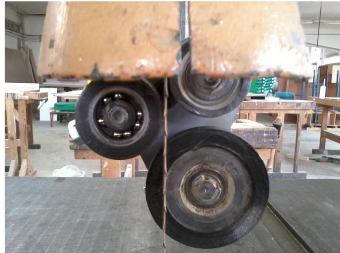
e) být nasazený na pásovnici tak, aby se při vedení ve vodítkách nevychyloval.
