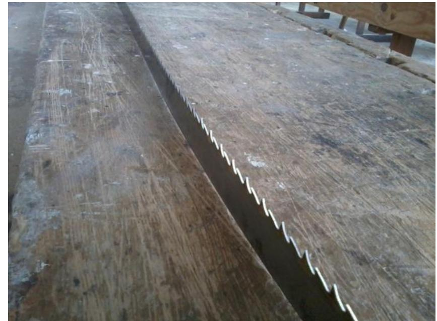
d) mít zuby rozvedené a naostřené rovnoměrně a přiměřeně k pilovému pásu a obráběnému materiálu, mimo část pilového spoje, aby tato část nebyla namáhána,
