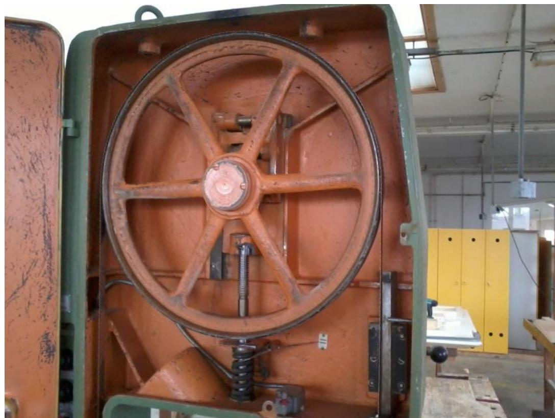
Ochranný kryt spodní vodící pásovnice musí být přizpůsoben pro připojení na odsávání.
