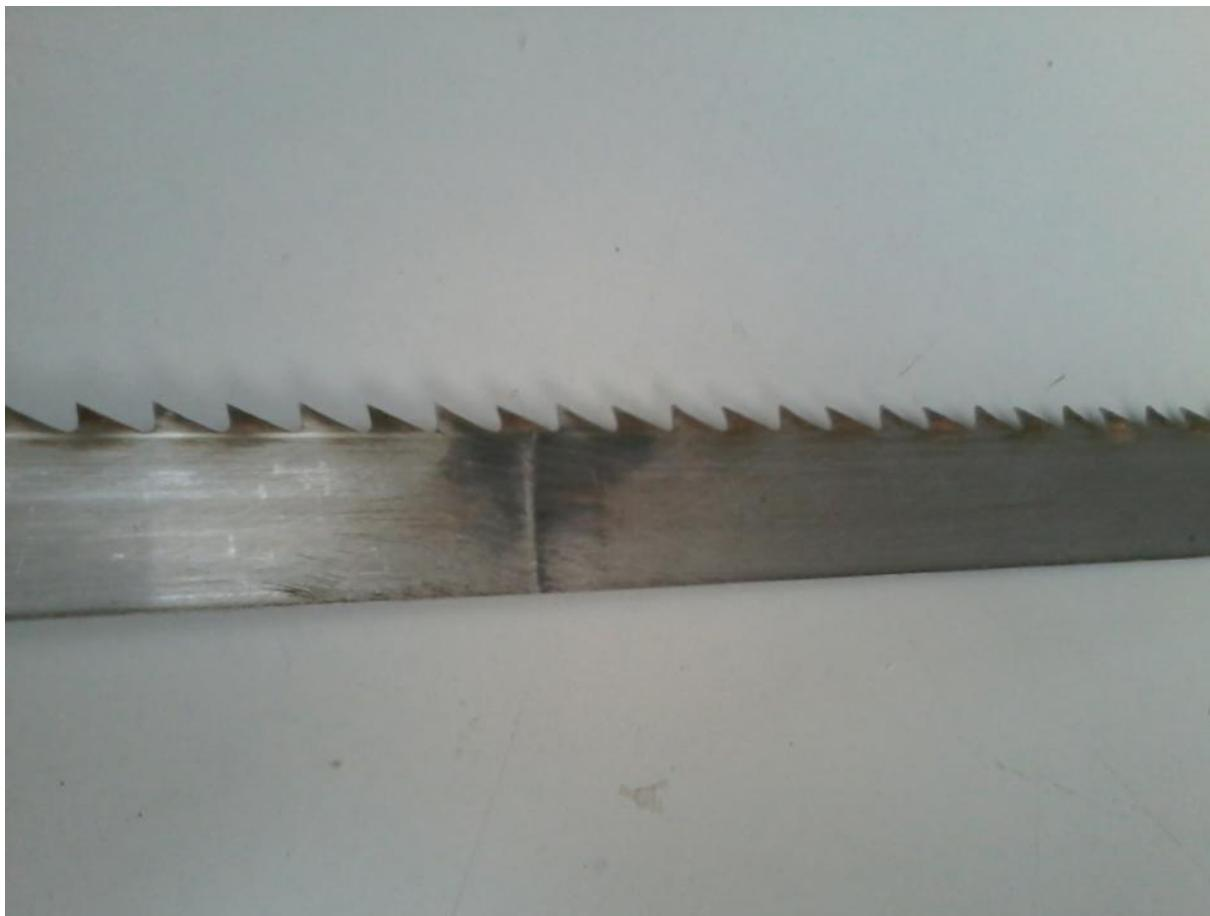
c) být rovný (bez vlnění a trhlin),
