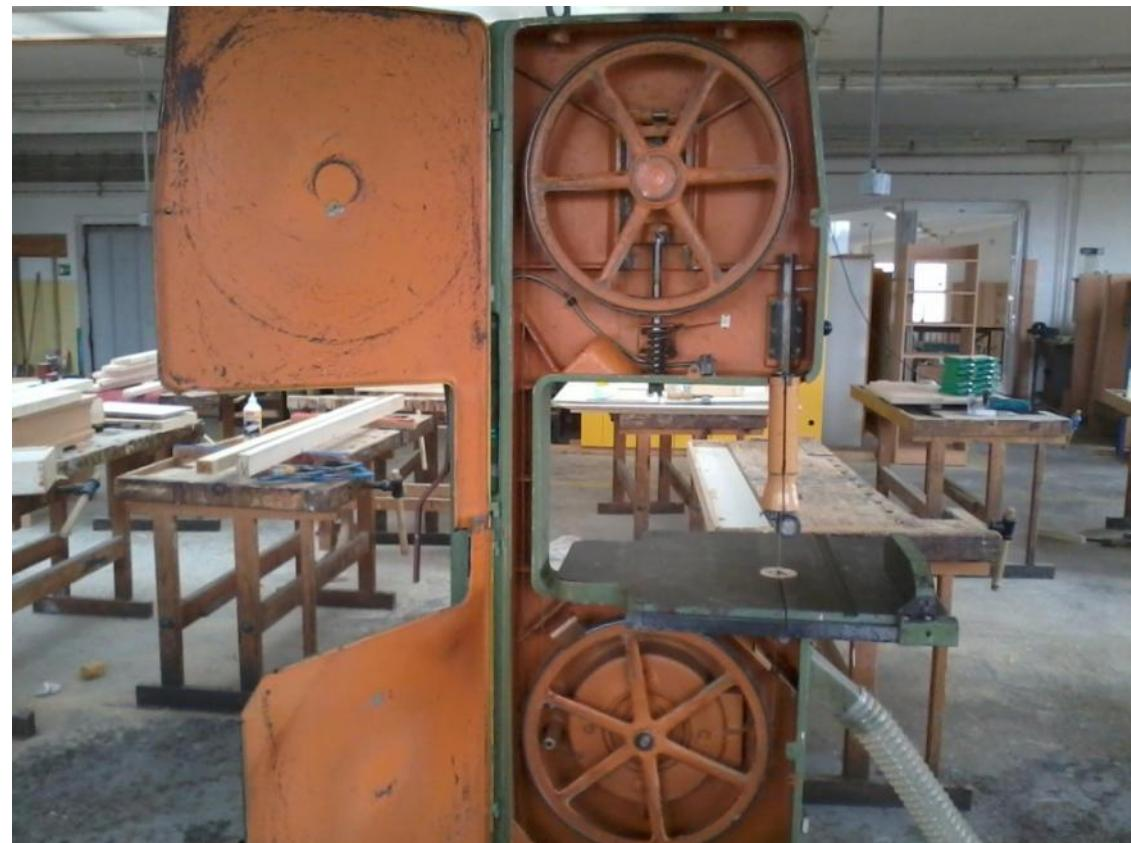
Vodítko pilového pásu musí být při řezání umístěno co nejblíže k řezanému materiálu.
