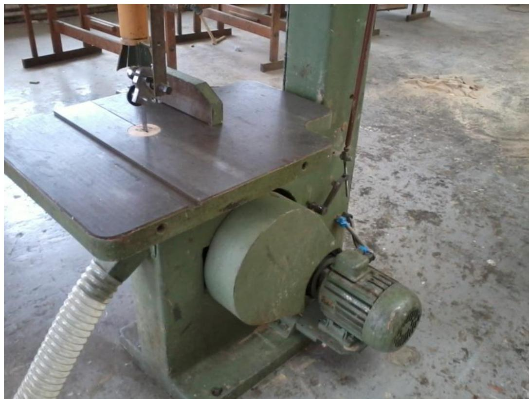
Stroje musí mít zařízení zajišťující stálé napnutí pilového pásu během práce.
