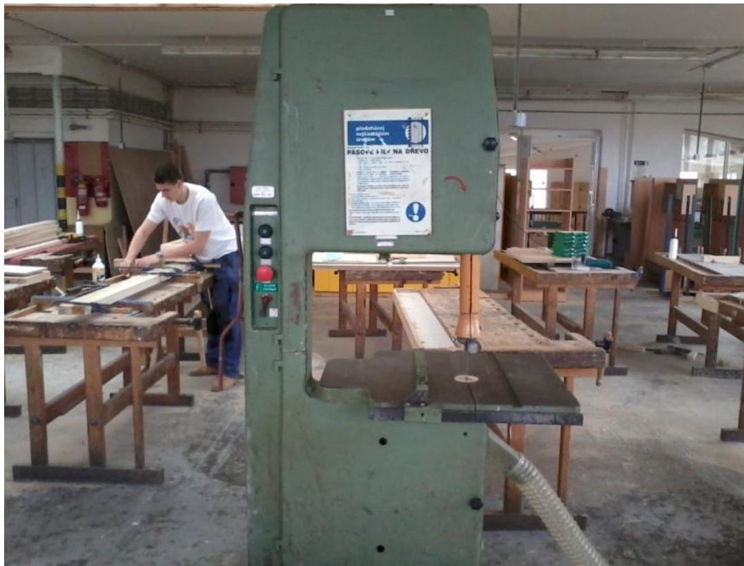
Pevnost ochranného krytu pásovnic musí zajišťovat bezpečnost pracovníků v případě přetržení pilového pásu.
