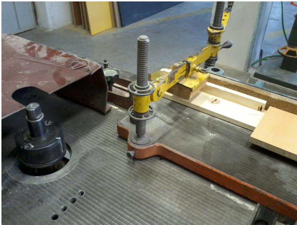
Frézovací nástroj u spodních frézek musí být jen kruhového průřezu.
