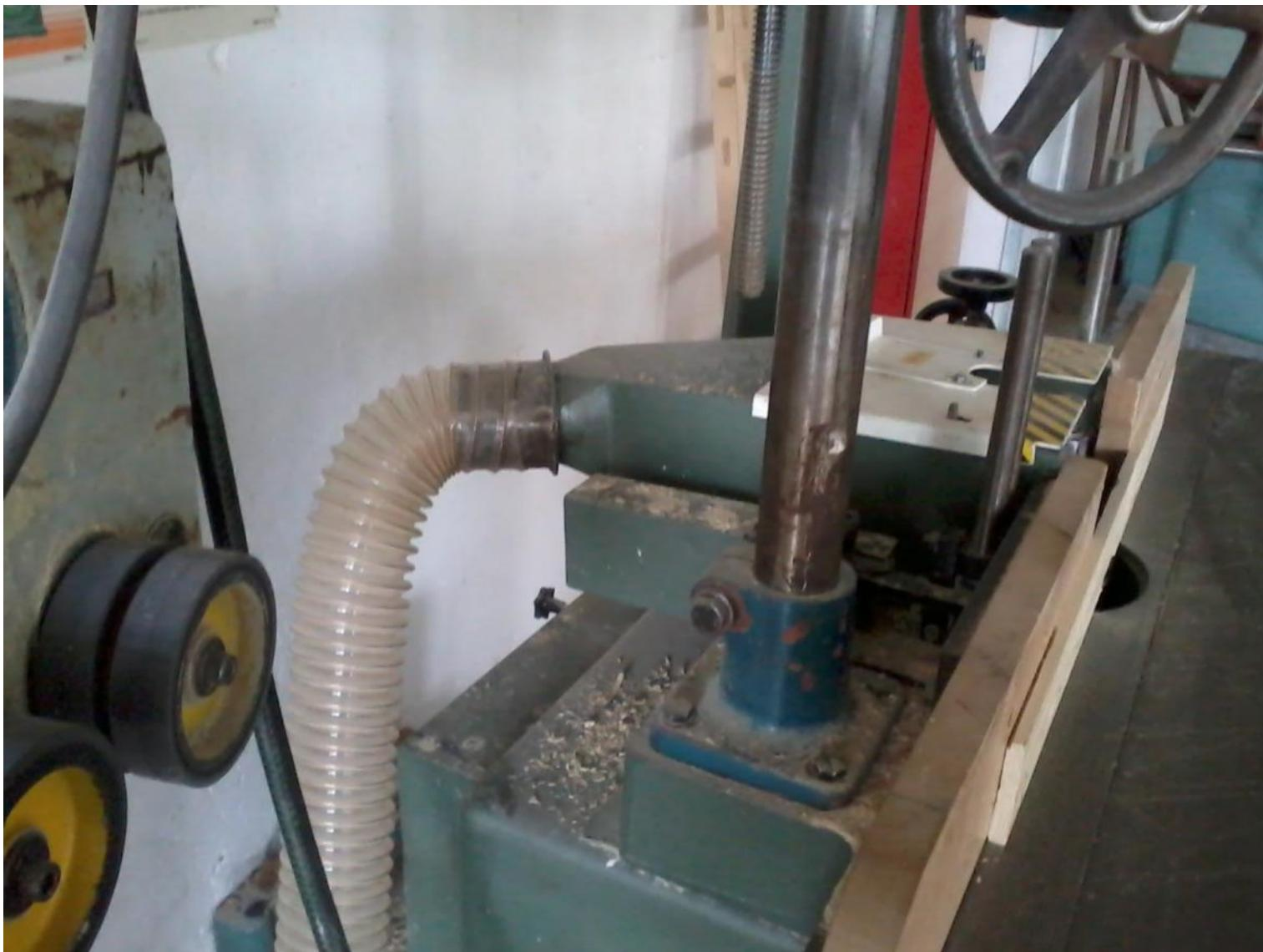
c) na nástavcích se nemají vyskytovat zbytečné netěsnosti a štěrbiny,
