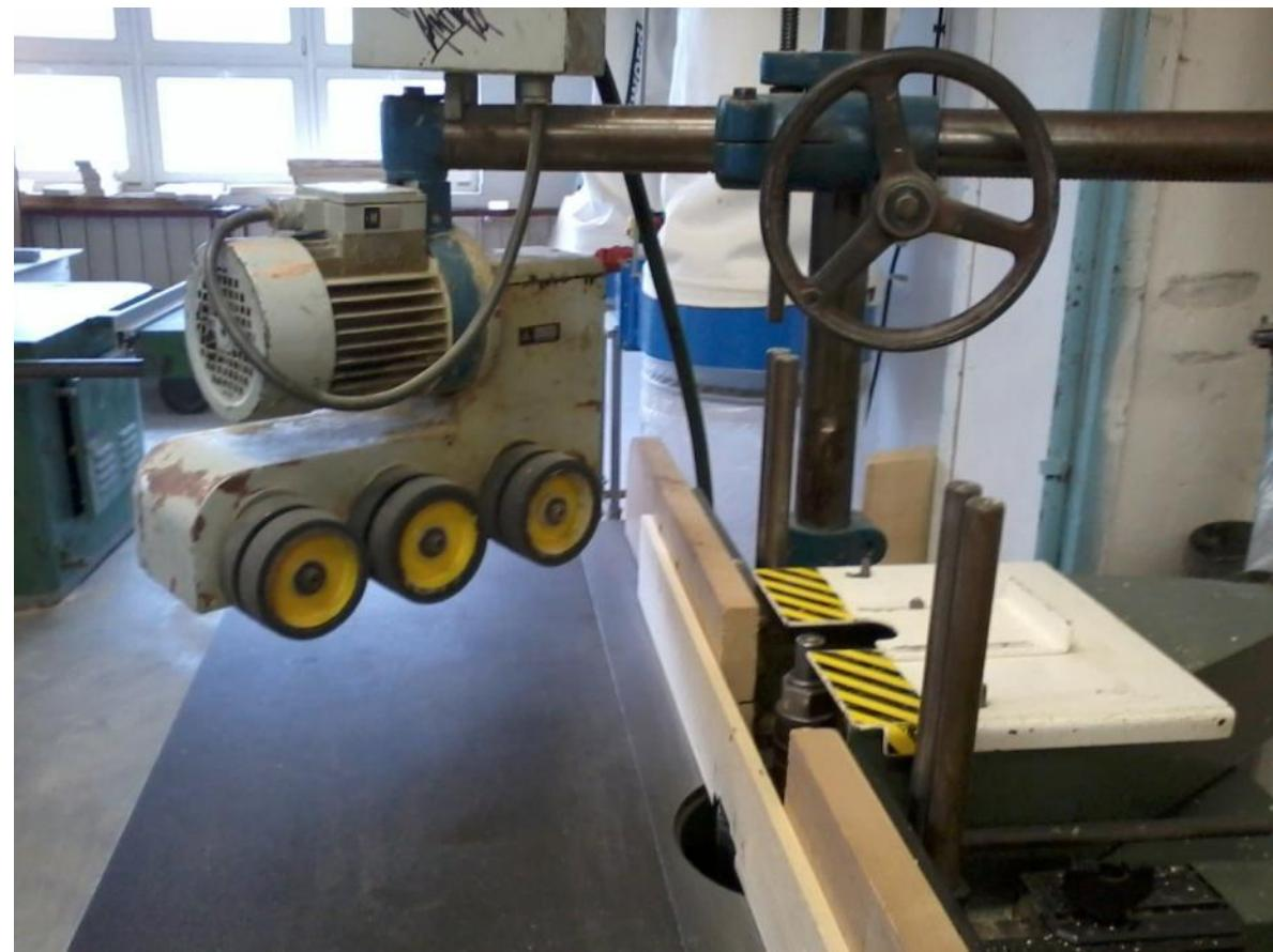
Při frézování čepů musí být výrobek řádně upnut v čepovacím vozíku
