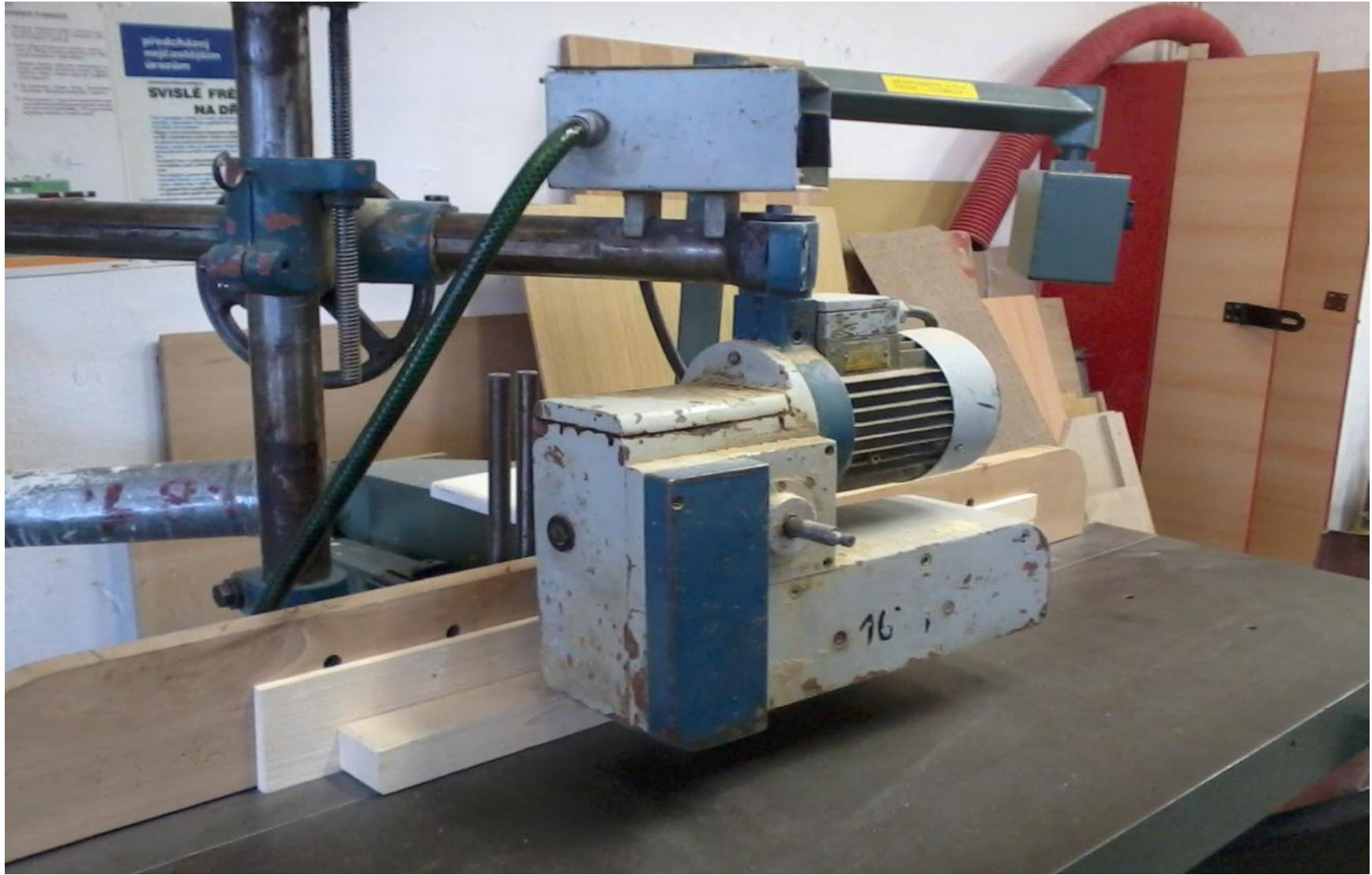
Zařízení na mechanické posouvání materiálu do řezu, odebírání výrobků a odpadu, musí za chodu stroje uzavírat pracovní prostor nástroje proti vložení rukou
