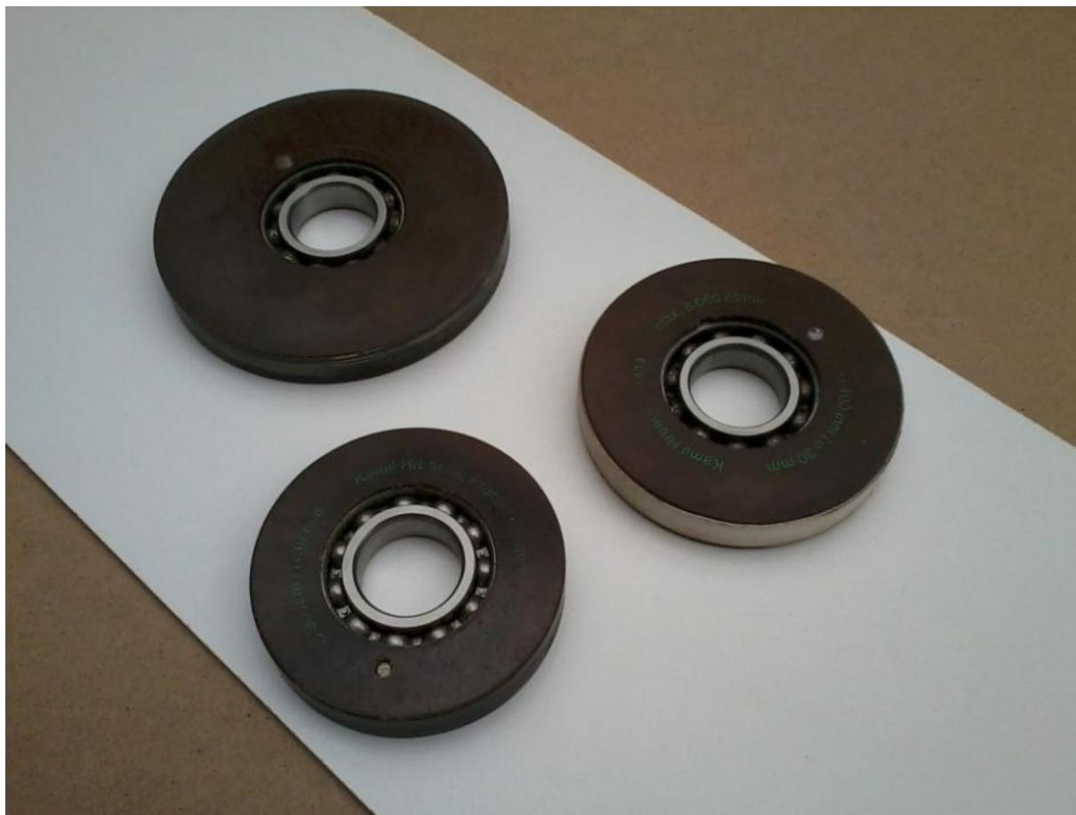
Při obrábění zakřivených a nepravidelných kusů se na vedení obrobku musí používat trny s vodícími kroužky a šablony na upínání obrobku, případně speciální upínací zařízení.
