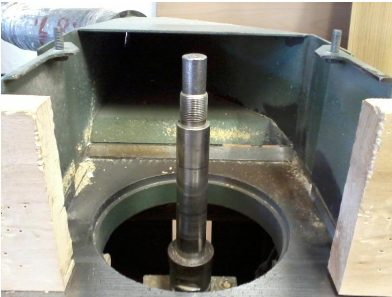
U spodních frézek nesmí průměr otvoru ve stole pro vřeteno převyšovat průměr smontovaného vřetene(nástroje) o více než 30mm.
